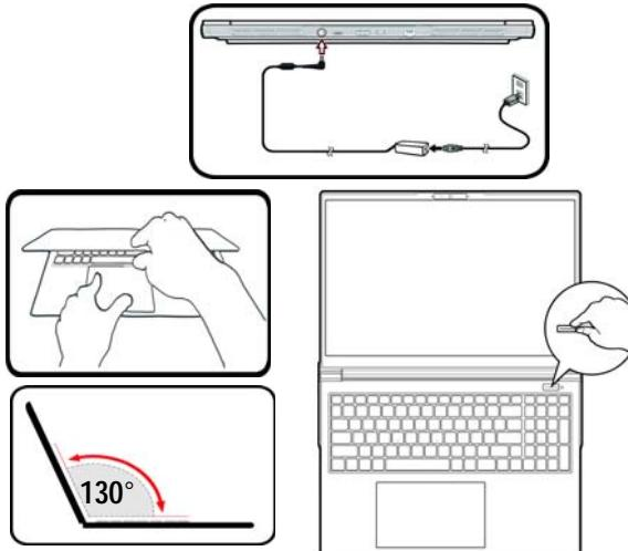
Figura 1 - Apertura del coperchio/Computer con alimentatore AC/DC collegato
