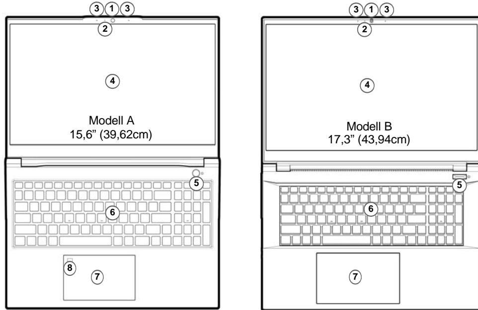
Abb. 2 - Ansicht von vorne mit geöffnetem Bildschirm
