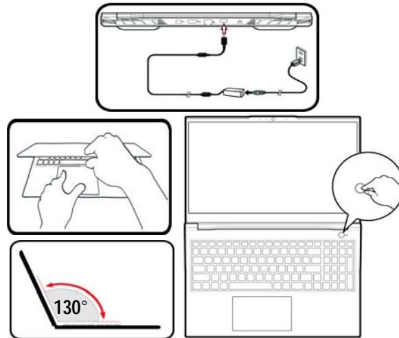
Abb. 1 - Öffnen des Dekkels/Computers mit angeschlossenem AC/DC-Adapter
