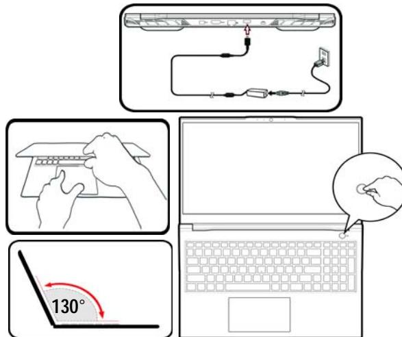
Figura 1 - Apertura del coperchio/Computer con alimentatore AC/DC collegato
