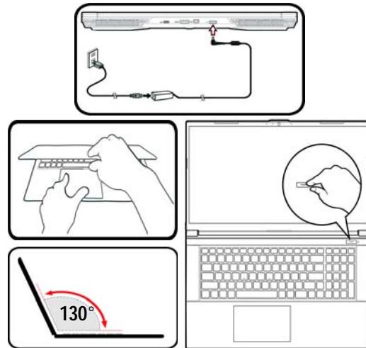
Figura 1 - Apertura del coperchio/Computer con alimentatore AC/DC collegato
