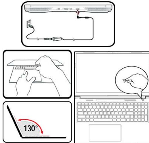
Abb. 1 - Öffnen des Dekkels/Computers mit angeschlossenem AC/DC-Adapter
