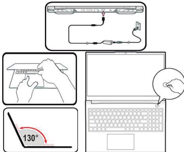
Figure a Abrir a tampa/computador com o adaptador CA/CC ligado
