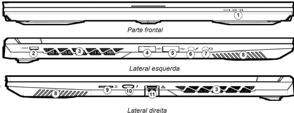
*Figura 3 - Vistas frontal, esquerda e direita (Modelo A)*
