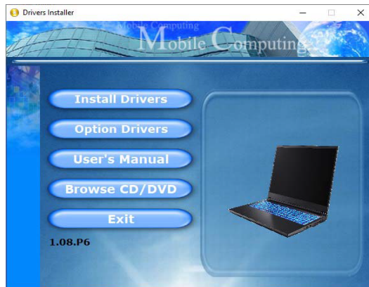
Figura 13 - Instalación de controladores
